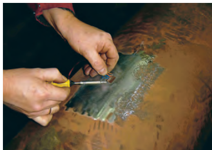
图7: 将应变仪放置在轴上。
